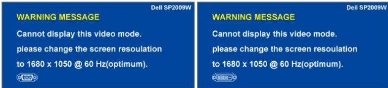
รูปหน้าจอ OSD ของเครื่องคอมพิวเตอร์ Dell SP2009W ที่แสดงข้อความเตือนการตั้งค่าการแสดงผลที่ไม่เหมาะสม (1) และ (2)
